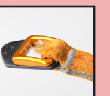
Band in der Schnalle aufgeschuert
