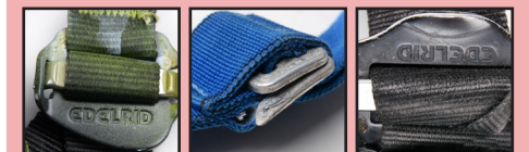
Farbe Korrosion Knick in der Fädellung
