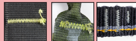
Mehrere Schlaufen gezogen Farbe/Chemikalien mehrere Stiche fehlen
